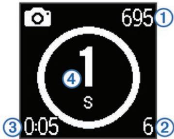
Устройство сделает серию снимков с заданным интервалом времени. На экране отображается оставшееся количество фотографий, которые могут быть сделаны устройством ①, количество сделанных фотографий ②, прошедшее время ③ и время до съемки следующей фотографии в секундах ④.
