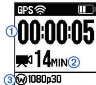
На экране отображается прошедшее время записи ①, доступное время записи ② и режим видеосъемки ③.
