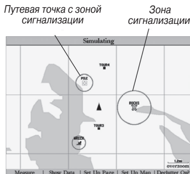
На экране появится окружность (красная), которая отмечает зону сигнализации вокруг путевых точек
