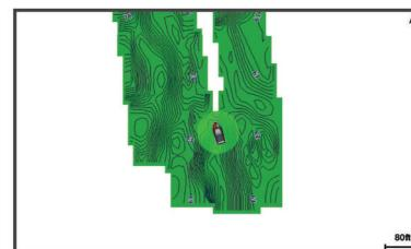
Зеленый круг обозначает хорошее качество регистрации глубины и высокую точность определения местоположения по GPS, а также скорость менее 16 км/ч (10 миль/ч). Желтый круг обозначает хорошее качество регистрации глубины и высокую точность определения местоположения по GPS, а также скорость в диапазоне между 16 км/ч и 32 км/ч (10 миль/ч и 20 миль/ч). Красный круг обозначает низкое качество регистрации глубины и точность определения местоположения по GPS, а также скорость более 32 км/ч (20 миль/ч).
