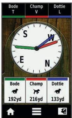
С помощью компаса для отслеживания собаки можно следить за направлением движения и пройденной дистанцией собаки. Компас для отслеживания собаки также показывает ее состояние, например бег или стойку ([Значки состояния собаки, стр. 6](#)). Цвет указателя совпадает с цветом трека собаки.
