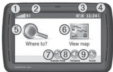
1. Мощность сигнала от GPS спутников.
